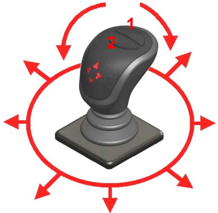
Abbildung 2: Bewegungen des Joystick
